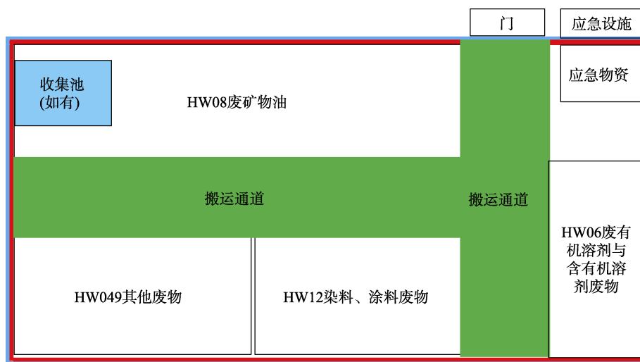
图 1 贮存分区示意图 Fig.1 Schematic diagram of storage zones
