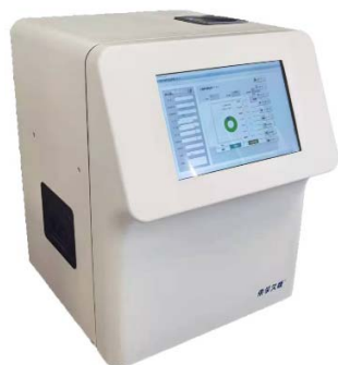
图 2 小麦不完善粒检测仪 Fig.2 Unsound wheat kernels detector
