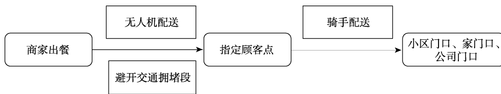
图 3 无人机结合骑手配送外卖的方式
