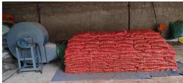
图 4 卧式箱笼堆垛花生荚果干燥设备实物图
