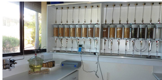
图 1 将恒定浓度的氮气和氧气通入气体充入系统内处理昆虫，同时 在处理期间系统内保持低二氧化碳浓度。15 个圆柱体都装有已知量（1.8~2 kg）的谷物（小麦、大麦、燕麦、羽扇豆和油菜籽），柱体内在 6 cm 和 23 cm 的深度布置有平纹细布制成的密封小袋，袋内装有 40~50 g 即>200 头混合虫龄的储粮害虫成虫。
