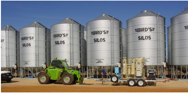
图 2 在西澳大利亚州 Lake Grace (33.117, 118.607)附近 Doug Clarke 附属的农场仓开展实仓实验。使用产量为 30 m 3 /h 99.5%N 2 的变压吸附 (PSA) 制氮机, 将氮气充入 75 t 储存小麦和油菜籽气密仓中。
