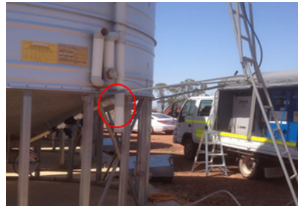
图 5 在筒仓锥体和侧壁的连接处, 热虹吸管的直径减小到 40 mm 排水排污管 (DNW), 直径变小的管道与地面磷化氢施放室相连, 充氮分接系统就是安装在这条管道上的。
