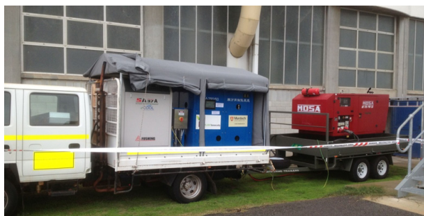
图 1 由空气压缩机、膜组件氮气发生装置和柴油发电机组成的移动式熏蒸装置，摄于 Kwinana 码头粮食仓库外。
