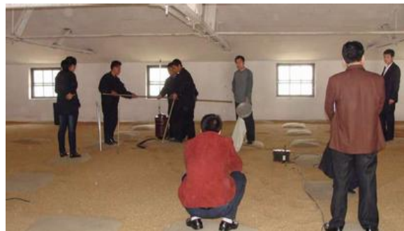
图 2 人工探杆测量粮堆高度 Fig.2 Manual measuring the height of grain pile
