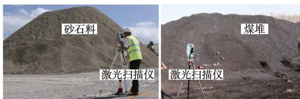
图 3 三维激光扫描仪测量
