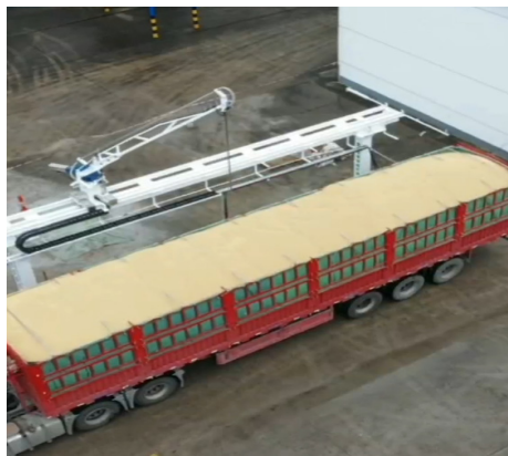
图 2 机械手式单扦智能扦样系统
