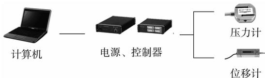
图4 数据采集系统连接方式
